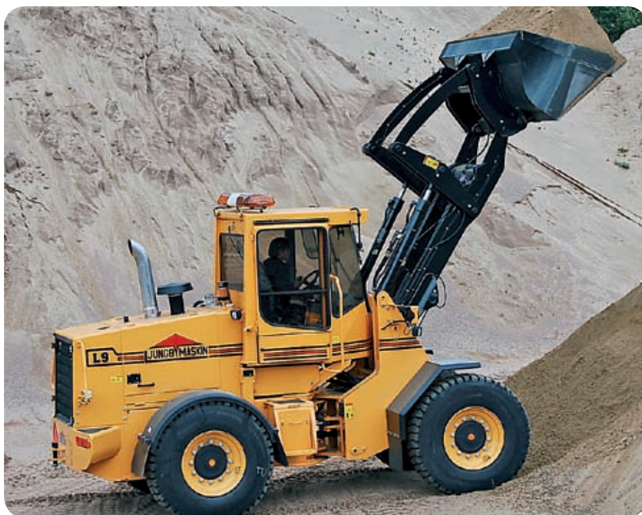
Hjullastaren Ljungbymaskin L9 levereras med diesel från Mercedes-Benz.
